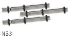
Diese Einheit misst – potentialgetrennt vom Regler – den **Füllstand von Speichern, Zisternen etc.** über den Stromfluss zwischen einer Referenzsonde und bis zu 5 Niveausonden in **wässrigen, leitenden Flüssigkeiten**. Im Grundpaket sind **drei Sonden zur Erfassung zweier Füllstände** enthalten. DL-Buslast: 5% (12V Versorgungsspannung notwendig) **Mit dem ergänzenden Set** aus 3 Niveausonden können insgesamt fünf Füllstände erfasst werden.
