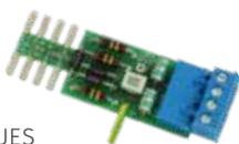
Robuster Überspannungsschutz für den CAN-Bus mit zwei Schutzstufen. Grundsätzlich kann der CAN-UES an jedem CAN-Knoten verwendet werden. Der CAN-UES ist zum direkten Einbau in die Konsole der UVR16x2 geeignet. Der CAN-UES2 im Universalgehäuse eignet sich zur Hutschienenmontage.
