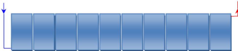
Die Kollektoren E-PVT 2.0 können Parallel verschaltet werden in Kollektorfelder, die max. 10 Stück Kollektoren enthalten, bei einer einseitigen Verbindung.
