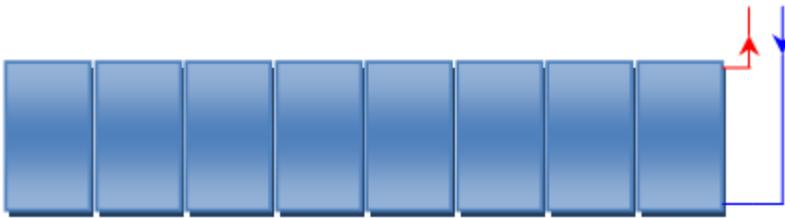
Die Kollektoren E-PVT 2.0 können Parallel verschaltet werden in Kollektorfelder, die max. 8 Stück Kollektoren enthalten, bei einer einseitigen Verbindung.
