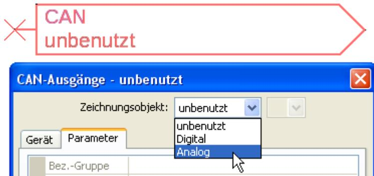
Verknüpfung mit der Quelle im Modul, von der der Wert für den CAN-Ausgang stammt.
