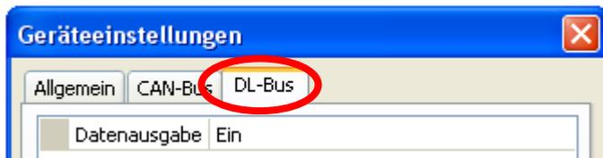
Im Menü Datei / Einstellungen / Geräteeinstellungen / DL-Bus kann die **Datenausgabe** für das **Datenlogging** über DL-Bus und für die Anzeigen im Raumsensor **RAS-PLUS** ein- oder ausgeschaltet werden. Für das **DL-Datenlogging** kann das C.M.I. und der Daten-
